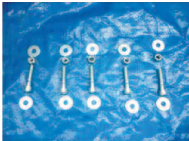
SCHRAUBE M8x45 TCEI UNTERLEGSCH. 8,4x24 h2 SICHERUNGSMUTTER M8
